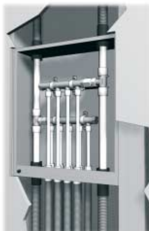
Fördelare i fördelarskåp med läckageindikering kan placeras där det passar praktiskt, läckageindikeringen kan dras till önskat utrymme.
