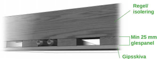
Förslag till placering av rör i glespanel i tak.
