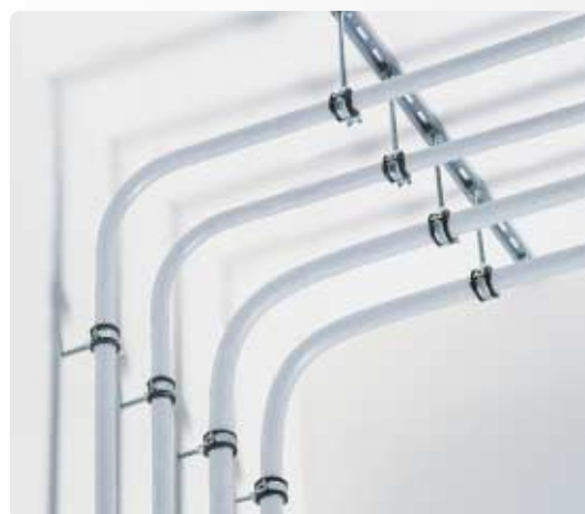
Rörens mellanskikt av aluminium gör dem enkla att bocka på önskat sätt. Du får en permanent böj som håller formen och underlättar installationen.
