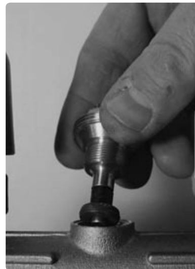
Skruva upp ventilöverdelen.
