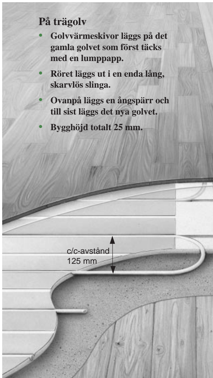
Enkel installation med golvvärmeskiva på ett befintligt trägolv med parkett eller plastmatta som övergolv.
